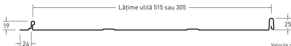
Valorile din secțiune sunt exprimate în mm.
