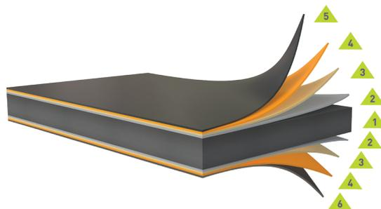
În cazul sistemului pluvial, ambele fețe ale tablei sunt protejate de strat de pasivare și sunt acoperite cu vopsea poliuretanică, cu strat de 35 μm, a cărei textură oferă o rezistență mare la uzură, zgârieturi și temperaturi ridicate.
